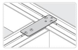
Установить большую соединительную пластину так же, как в соединении под прямым углом
