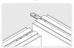
Установить малые соединительные пластины в пазы соединяемых под прямым углом светильников
