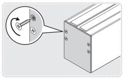
Установить торцевые заглушки на конечные светильники в линии
