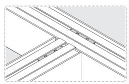
Установить малые соединительные пластины в пазы соединяемых светильников
