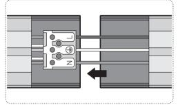
Произвести подключение следующего светильника в линии:
