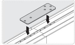
Установить большую соединительную пластину
