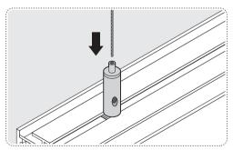
Закрепить светильник на тросовых подвесах, пропустив трос в верхнее отверстие цангового зажима
