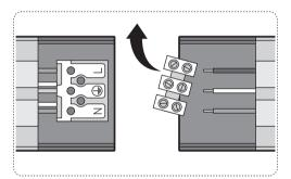
Снять винтовую колодку с магистральных проводов
