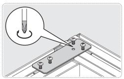
Совместить отверстия соединительных пластин и закрепить их винтами между собой
