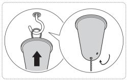
Закрыть шуруп-полукольцо декоративным колпачком, зафиксировав колпачок саморезом
