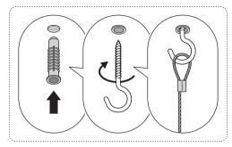
Закрепить шуруп-полукольцо на поверхности потолка. Зацепить трос за шуруп-полукольцо
