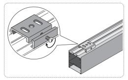
Зафиксировать светильник, затянув винтом боковую площадку скоб крепления
