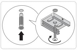
Закрепить на поверхности потолка скобы крепления
