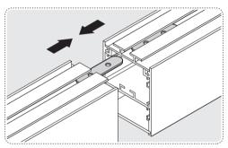
Установить малые соединительные пластины в пазы соединяемых в линию светильников
